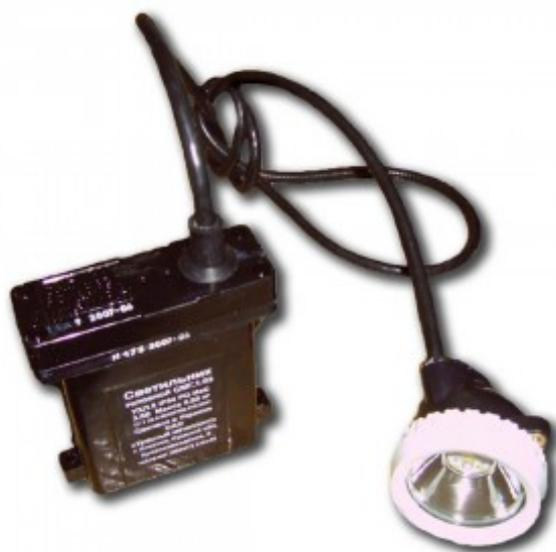
Светильник головной СМГ.1.03 предназначен для освещения рабочего места в выработках шахт. Светильник имеет исполнение по уровню и виду взрывозащиты РО Ia С, климатическое исполнение УХЛ 5; степень защиты оболочки IP 54.
