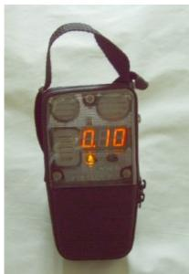
Измерители метана, кислорода, токсичных газов и температуры Сигнал 9, которые являются приборами индивидуального пользования и предназначены для измерения объемной доли метана (СН4), кислорода (О2), токсичных газов (оксида углерода (СО), сероводорода (H2S), диоксида азота (NO2), аммиака (NH3)) и температуры воздуха, выдачи световой и звуковой сигнализации при достижении установленных значений объемной доли метана, кислорода или токсичных газов в воздухе шахт.
