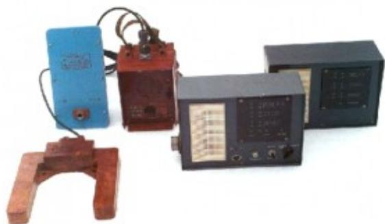
Предназначена для оперативной сигнализации и связи между машинистом шахтного подъема и персоналом на подъемном сосуде при ведении осмотровых и ремонтных работ в вертикальных шахтных стволах, а на клетевых подъемных установках и для связи между машинистом подъема и пассажирами в клетки в случае экстремальных ситуаций. Система имеет две модификации СШСС.1.1 и СШСС.1.2, работающие на несущих частотах 130 и 160 кг
