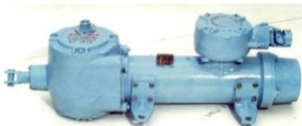
Предназначен для управления стрелочным переводом рельсовых путей угольных шахт. Привод рассчитан на эксплуатацию в шахтах, опасных по взрыву газа и пыли, где требуется применение электрооборудования в рудничном взрывобезопасном исполнении, а также в других отраслях промышленности. Привод может работать в условиях холодного, умеренного и
