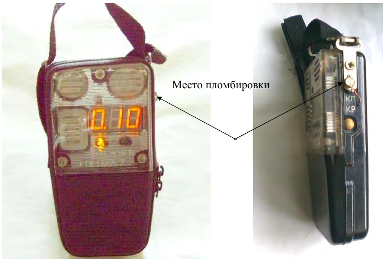
Общий вид прибора с указанием места пломбировки
